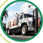
**Equipo de succión y limpieza “vector”:** Es un vehículo utilizado para ejecutar labores de limpieza en las redes de alcantarillado.
