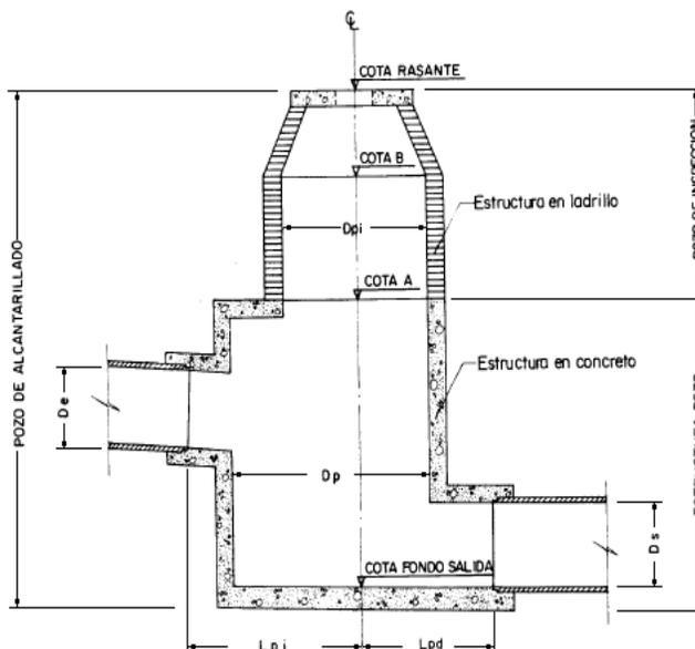
El diámetro interno de los pozos o cámaras de inspección dependen del diámetro de los colectores de salida, de acuerdo con la **tabla 10**.
