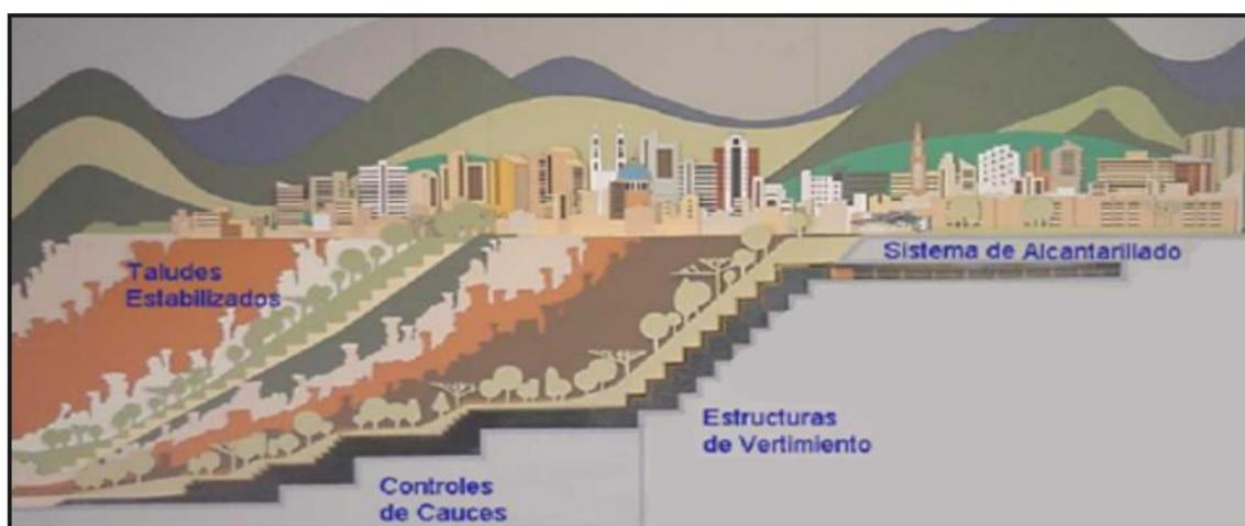
**Figura 18.** Esquema de obras del PGCE y el sistema de drenaje para La Meseta de Bucaramanga y su tratamiento no convencional.
