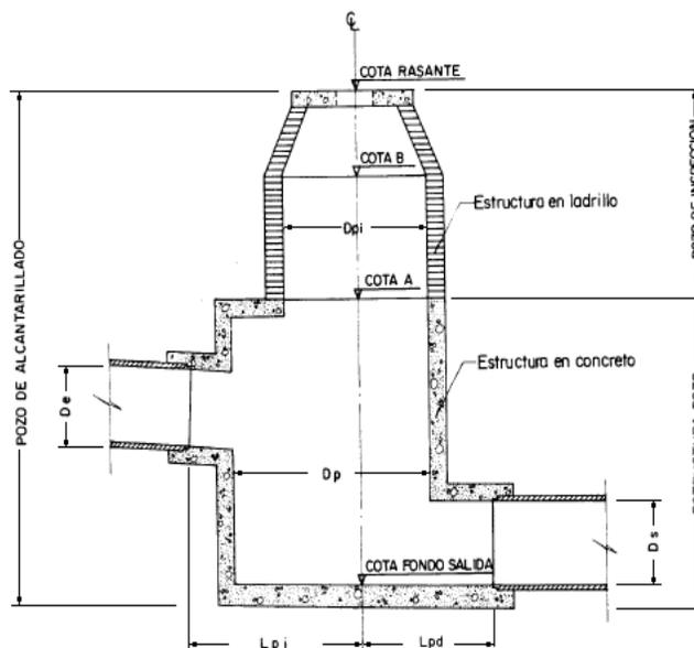
El diámetro interno de los pozos o cámaras de inspección dependen del diámetro de los colectores de salida, de acuerdo con la *tabla 11*:
